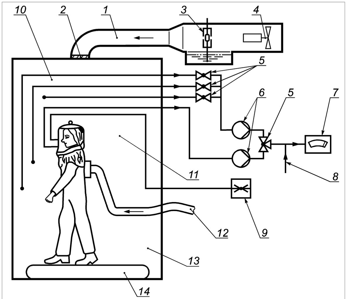
1 - трубопровод; 2 - дефлектор; 3 - распылитель; 4 - побудитель расхода воздуха; 5 - клапаны; 6 - насосы; 7 - пламенный фотометр; 8 - дополнительная подача чистого воздуха; 9 - манометр; 10 - система отбора проб из испытательной камеры; 11 - система отбора проб из зоны дыхания; 12 - подача воздуха для дыхания; 13 - испытательная камера; 14 - беговая дорожка
