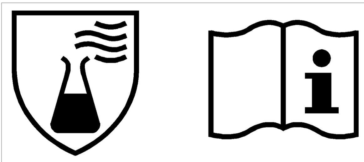
Рисунок 4 - Пиктограмма N 2414, обозначающая защиту от химических веществ, и пиктограмма N 1641 "См. указания по эксплуатации" (см. [9])
