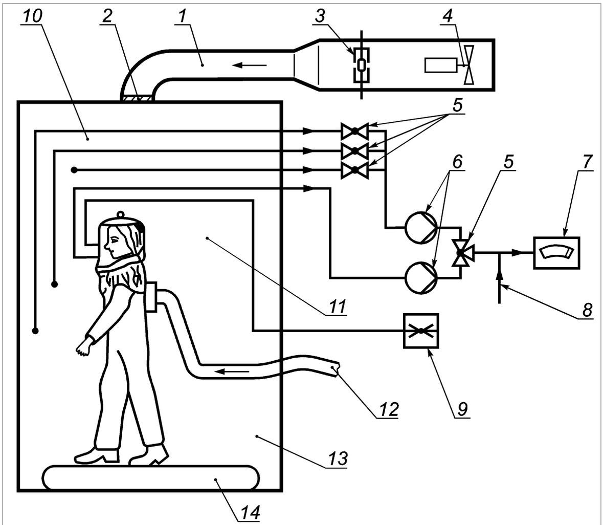
1 - трубопровод; 2 - дефлектор; 3 - распылитель; 4 - побудитель расхода воздуха; 5 - клапаны; 6 - насосы; 7 - детектор для определения гексафторида серы; 8 - дополнительная подача чистого воздуха; 9 - манометр; 10 - система отбора проб из испытательной камеры; 11 - система отбора проб из зоны дыхания; 12 - подача воздуха для дыхания; 13 - испытательная камера; 14 - беговая дорожка
