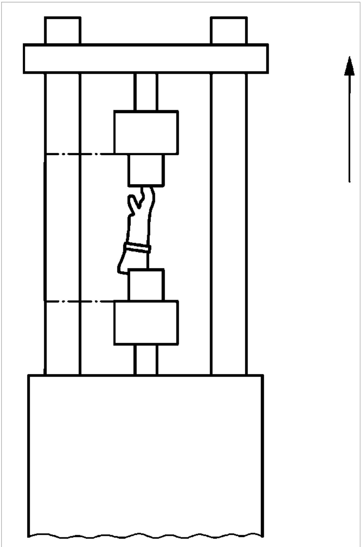
Рисунок 2 - Пример испытания на растяжение соединения перчатки с рукавом
